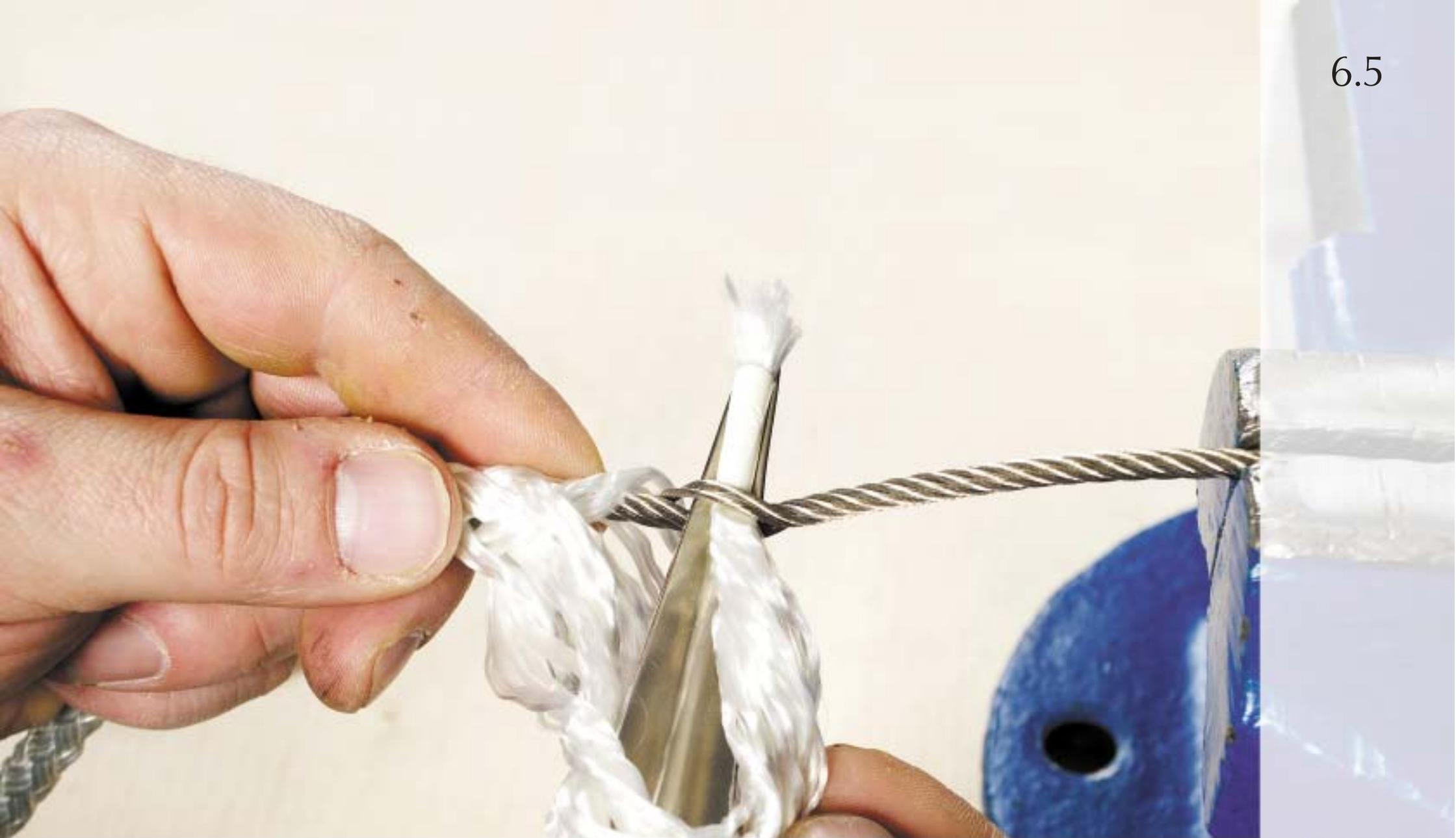
Die erste Litze mit Hilfe des Hohlspiekers unter 2 Drahtlitzen durchziehen.
