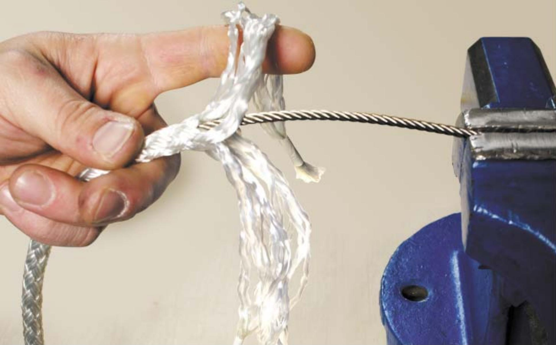
Drahtende im Schraubstock einspannen, und dann 3 etwa gleichgroße Litzen aus dem ca. 15 cm geöffnetem Geflecht bilden.
