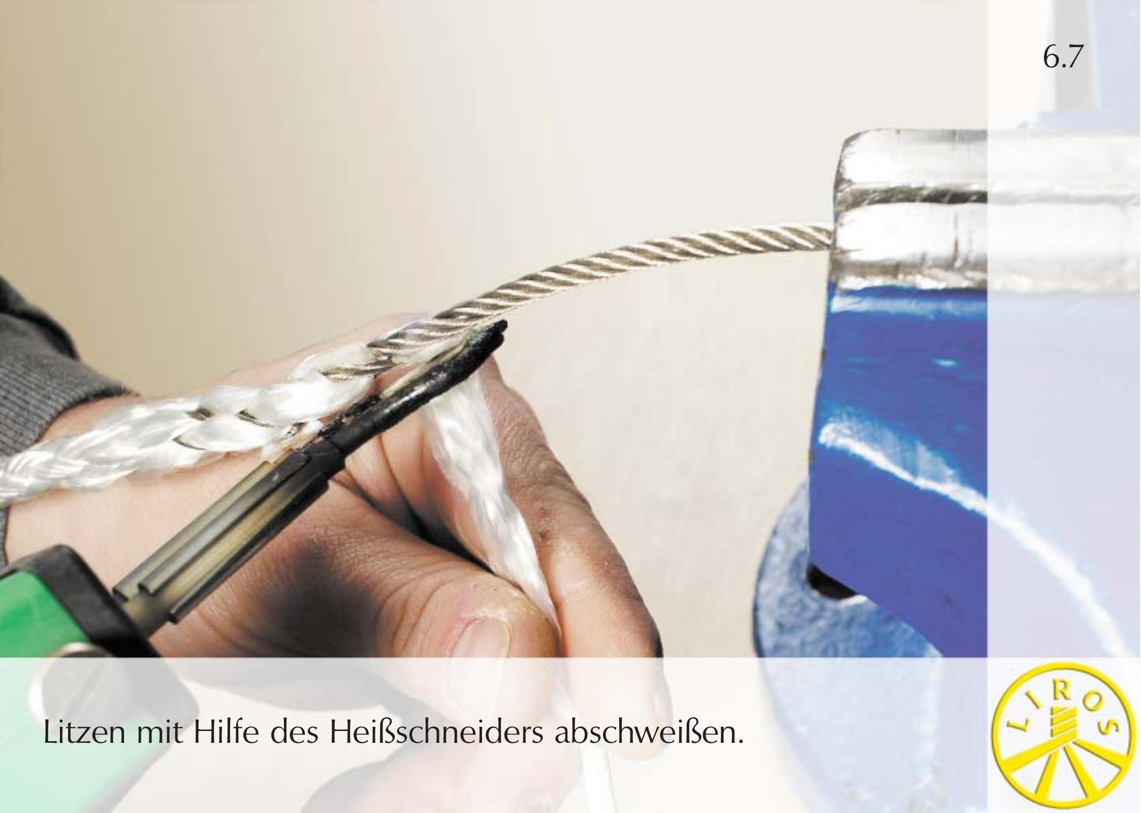
Litzen mit Hilfe des Heißschneiders abschweißen.
